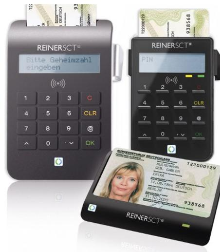
Abbildung 2.11.: Komfort-, Standard- und Basislesegerät - Quelle: [35]
