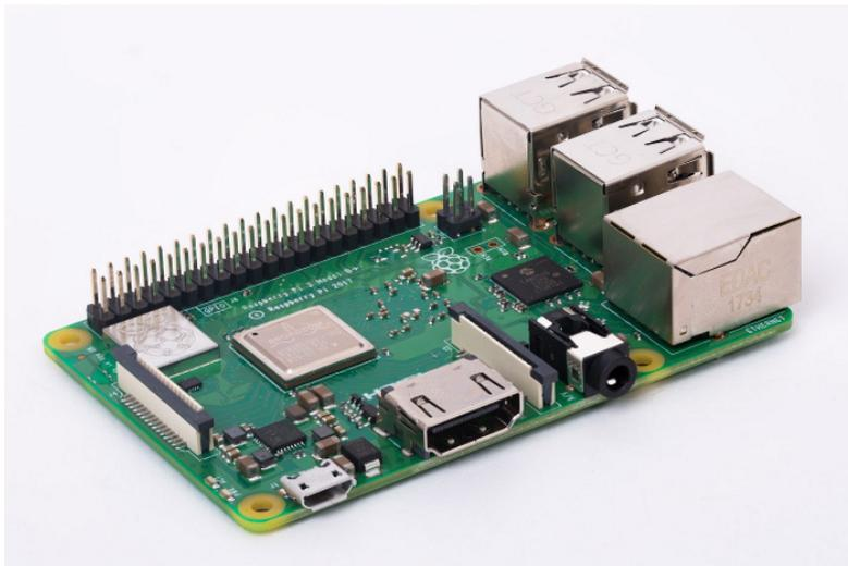
Abbildung 3: Raspberry Pi 3 Model B+ (Quelle: [8])
