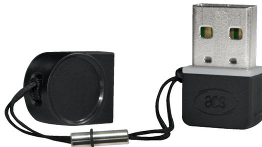
Abbildung 5: CryptoMate Nano USB-Token (Quelle: [14])
