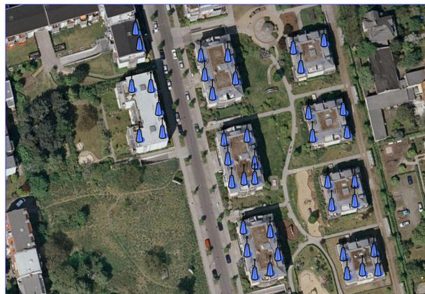
Abbildung 5.4: Für die Platzierung der APs lagen die Positionen von DSL-Anschlüssen vor. Es wurde dabei angenommen, dass an jedem Anschluss ein DSL-Router steht, welcher gleichzeitig mit einem WiFi-AP ausgestattet ist. Diese Abbildung zeigt eine Illustration.
