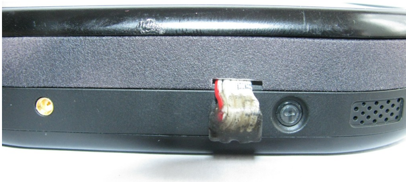
Abbildung 5.2.: OpenMoko mit Gehäuseerweiterung und eingebautem Reader
