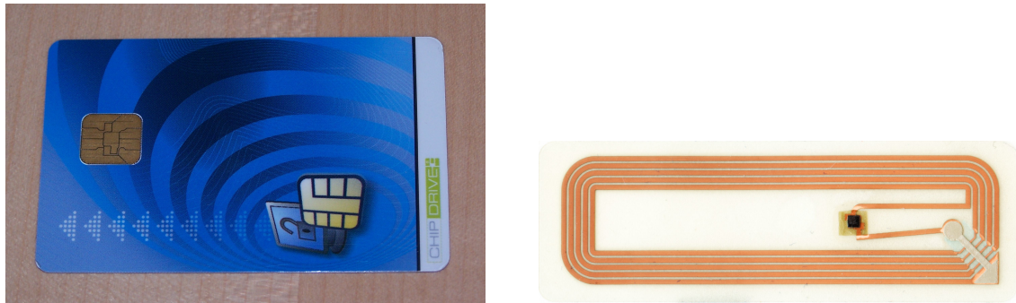
Abbildung 1: Links: kontaktbehaftete Chipkarte mit sichtbaren Kontaktflächen 1 ; Rechts: Innenansicht einer kontaktlosen Chipkarte 2 (Chip und gewickelte Antenne)
