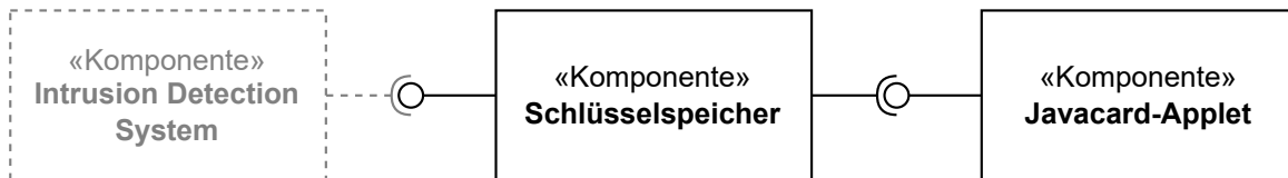
Abbildung 1: Vereinfachtes Komponentendiagramm. Verbindungen mit einem Kreis am Ende stehen für eine Schnittstelle, die von der entsprechenden Komponente angeboten wird. Ein Halbkreis steht dementsprechend für eine verwendete Schnittstelle. Der Schlüsselspeicher ist eine Java-Programmbibliothek, dessen öffentliche Methoden vom IDS gerufen werden können. Das Javacard-Applet wird auf einer Javacard installiert und stellt Funktionen bereit, die wiederum vom Schlüsselspeicher gerufen werden. Da das IDS nicht Teil dieser Arbeit ist, wird dieses in grau dargestellt.
